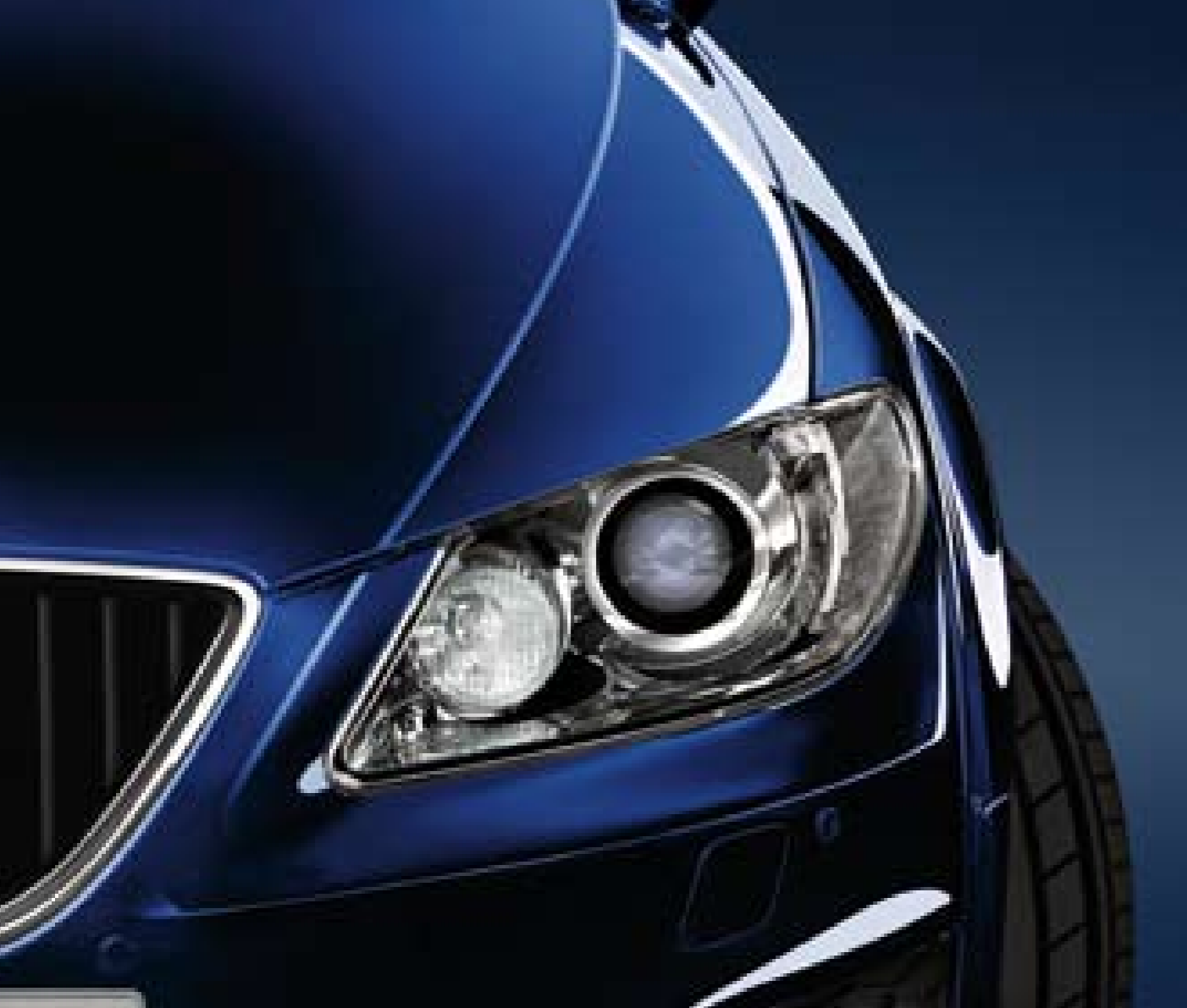
Der Lichtkegel des dynamischen Kurvenlichts folgt dem Lenkradeinschlag und leuchtet kurvenreiche Straßen noch besser aus.
